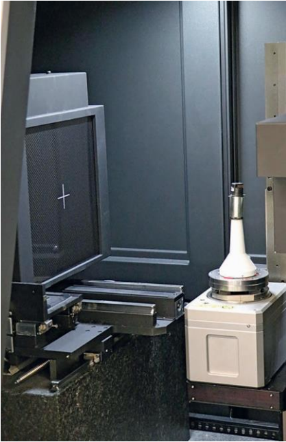
Maxon utilise notamment le Tomoscope S pour examiner des moteurs complets et visualiser tous leurs composants internes. © Werth Messtechnik
