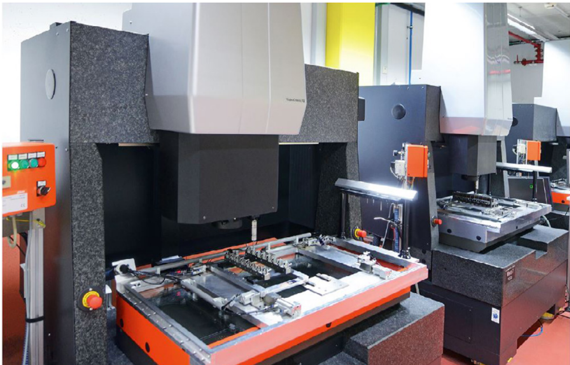
Photo 2 : Pour des tâches de mesure haute précision, les machines VideoCheck atteignent, dans la classe de précision la plus élevée, des erreurs de mesure de longueur de l'ordre du dixième de micron
