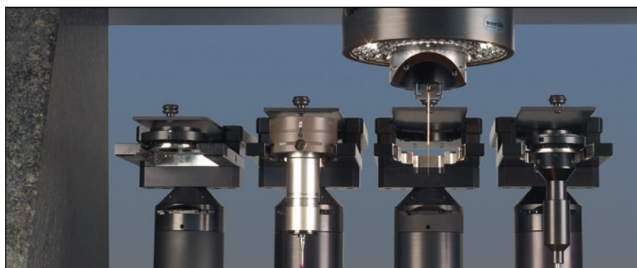
WFP/S Werth Fiber Probe sur WMS Multisensor System, avec en arrière-plan les autres sensors
